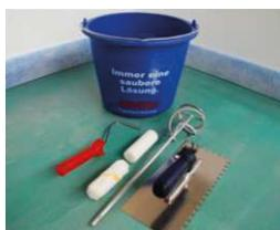
benötigte werkzeuge für eine fachgerechte und ordnungsgemäße bearbeitung des untergrunds: eimer zum anrühren des klebers, rührreihen mit akkuschrauber oder bohmaschine, kombinierte glättkelle mit 6 x 6 mm zahnung, malerrolle mit lammfell oder schaumstoffwalze zum auftragen der grundierung.
