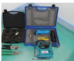
benötigte werkzeuge für eine fachgerechte und ordnungsgemäße bearbeitung der systemelemente, abdeckbleche und der zum system gehörenden rohre und rahmenhölzer: cuttermesser, stichsäge, kalibrierwerkzeug, rohrschere, blechschere.
