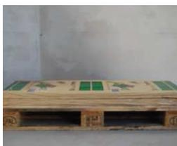
den trockenbau-unterboden TB UB 10 in geschlossener verpackung mindestens 48 stunden vor der verlegung in dem raum, in dem er verlegt werden soll oder in einem raum mit gleicher temperatur lagern. die raumtemperatur darf 18 °C nicht unterschreiten.
