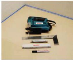
zur verlegung des trockenbau-unterbodens TB UB 10 werden ein stabiles cuttermesser, eine stichsäge, ein gliedermaßstab und eventuell ein anschlagwinkel zum anzeichnen benötigt.
